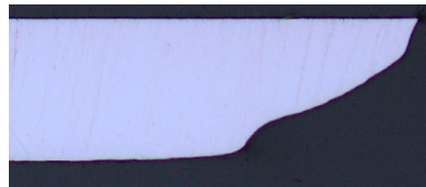
„Micrometal“ geätzt 1 scharfe Seite, 1 glatte Seite
